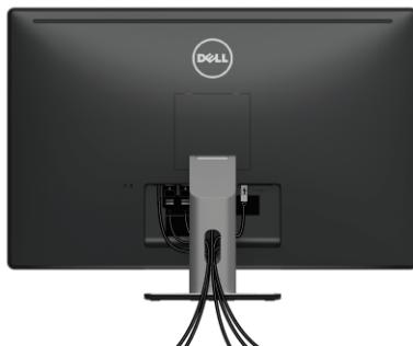
После подключения всех необходимых кабелей к монитору и ПК (см. [Подключение монитора](#) для подключения кабелей) воспользуйтесь отверстием для прокладки кабелей, как показано выше.
