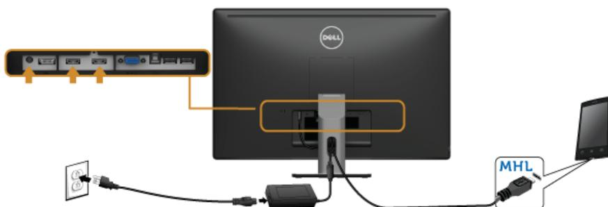
4. В экранном меню монитора (подробности [Использование экранного меню](#) см. в разделе) в качестве источника входного сигнала выберите HDMI (MHL) 1 или HDMI (MHL) 2.
